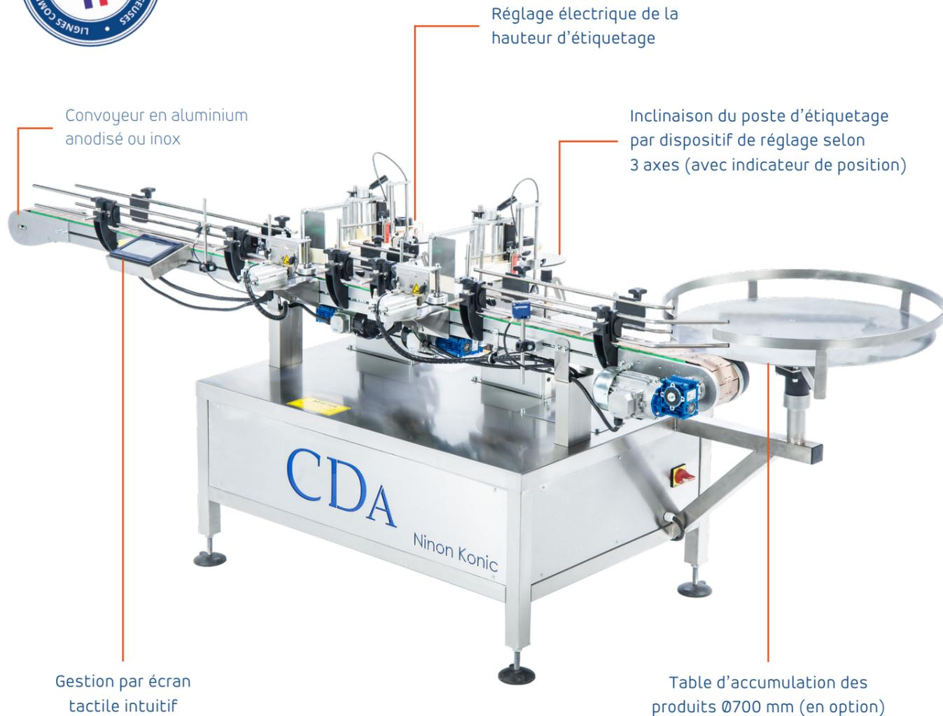
Convoyeur en aluminium anodisé ou inox
