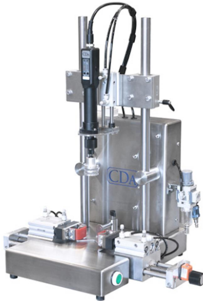
**Die VS100 ist eine halbautomatische Verschließmaschine, die ausgestattet ist mit :**
